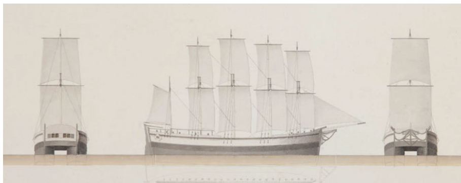
Figur 1. Ritning av Experiment of Leith . Farkosten var 32 meter lång över däck, bredden av varje skrov 3,7 meter, största bredd 9,7 meter, djupgående 2,1 meter. Skovelhjulen, som var fyra alternativt fem till antalet, hade en diameter på 2,1 meter och drevs med koniska växlar för kraftöverföring via två gångspel. Gångspelen drevs av manskapet ombord och farten uppgavs till 4,3 knop. 2
