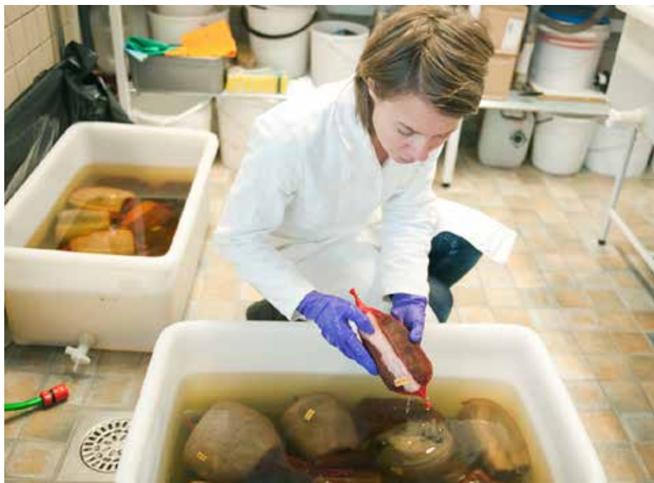
Konservator Malin Sahlstedt med träföremål från skeppet i bad med DTPA. Foto: Anneli Karlsson, SMM.
